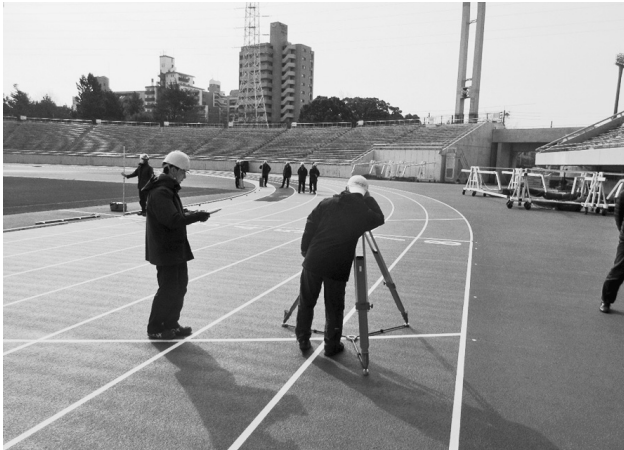
瑞穂競技場「IAAFクラス2」検定 1マイルスタートからオープン合流地点を光波で測定
